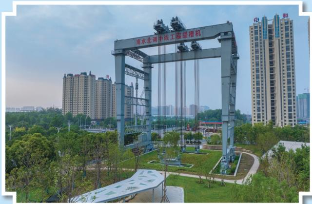
沙河渡槽工程使用的提槽机
